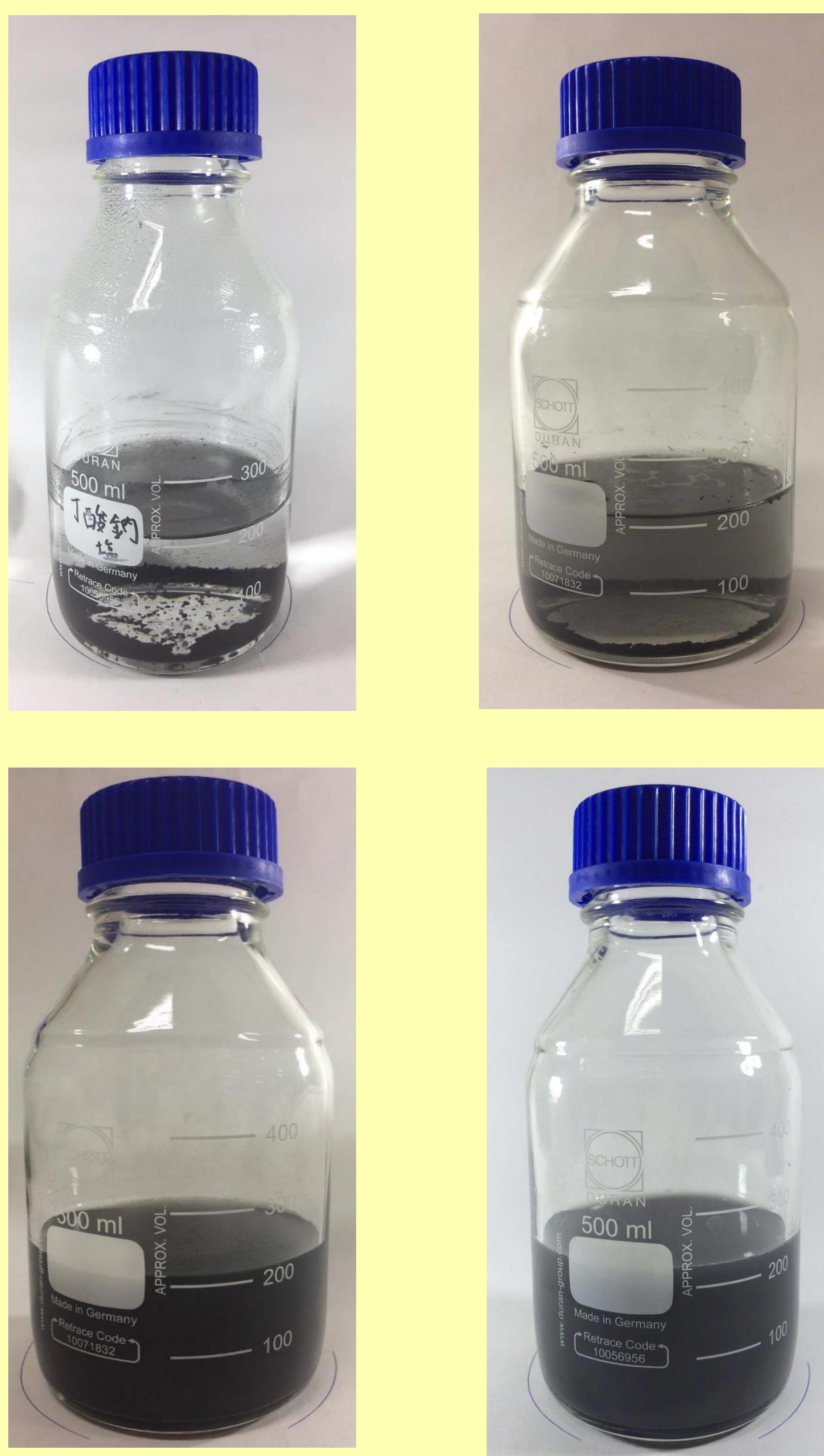
圖一、丁酸鈉鹽含石墨(左上)、辛酸鈉含石墨(右上)、月桂酸鈉含石墨(左下)、硬脂酸鈉含石墨(右下)四罐分散液
