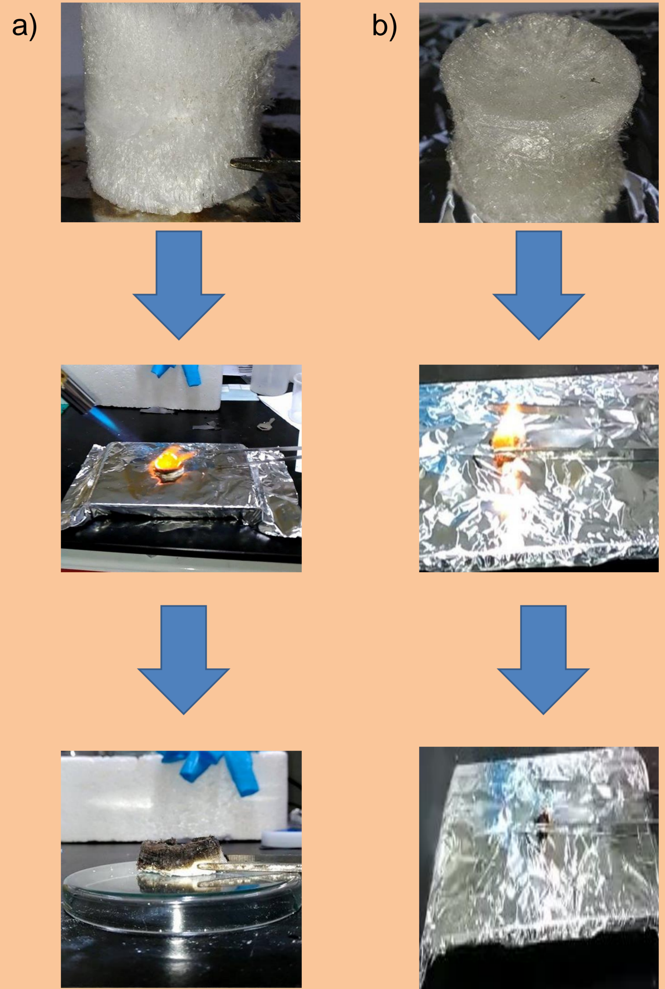
Figure 4. 氣凝膠防火測試圖 (a) 雲母氣凝膠經過大火過後仍能保持完整 (b) 未摻雜雲母的氣凝膠最後只剩下灰燼。
